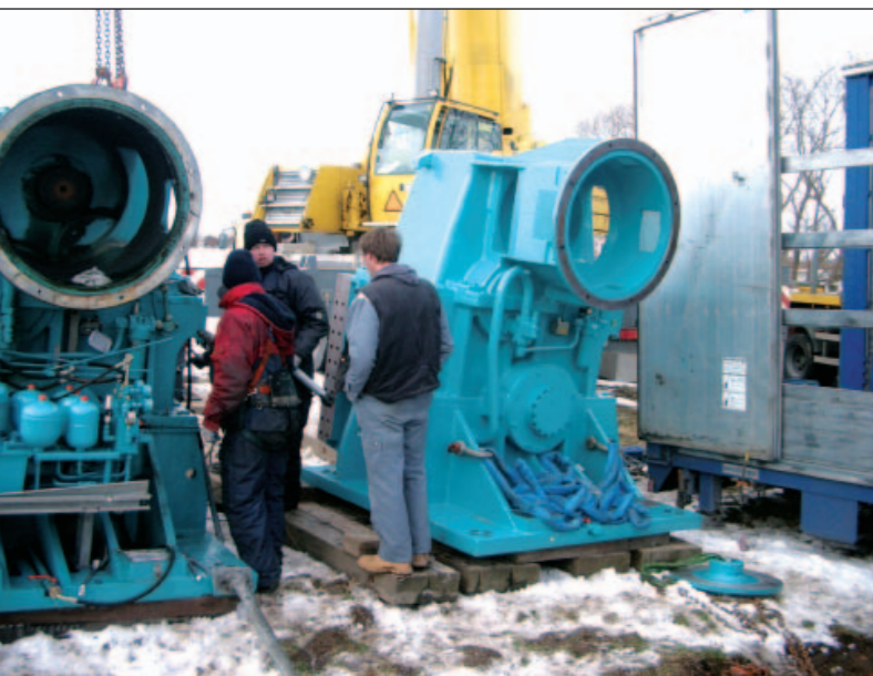
Das überarbeitete Tauschgetriebe kommt auf die Baustelle, das alte Getriebe geht zur Überarbeitung weg. Unten : Neue Lager.
