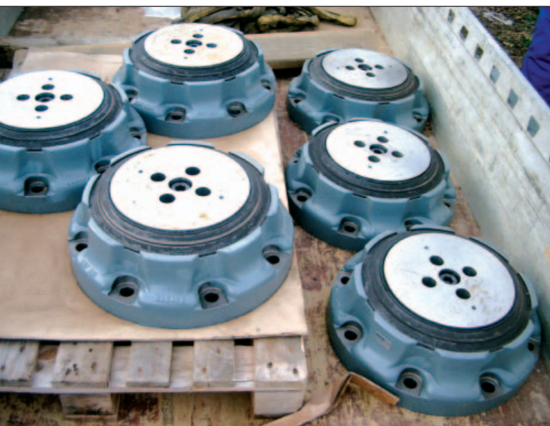
Das überarbeitete Tauschgetriebe kommt auf die Baustelle, das alte Getriebe geht zur Überarbeitung weg. Unten : Neue Lager.
